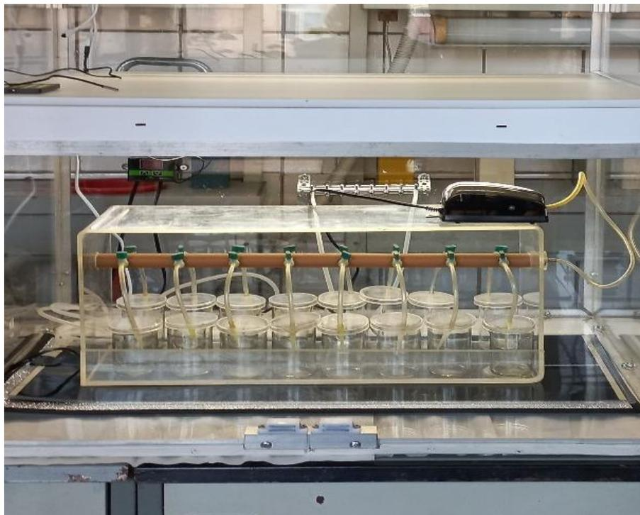
Рисунок 7.1 – Експериментальна установка для проведення тестів з цільними донними відкладами
