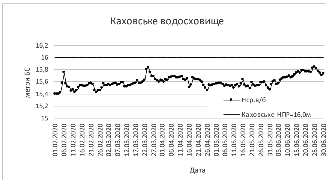
Рис. 3.4. Добові рівні води в Каховському водосховищі в перед нерестовий та нерестовий періоди 2020 р.
