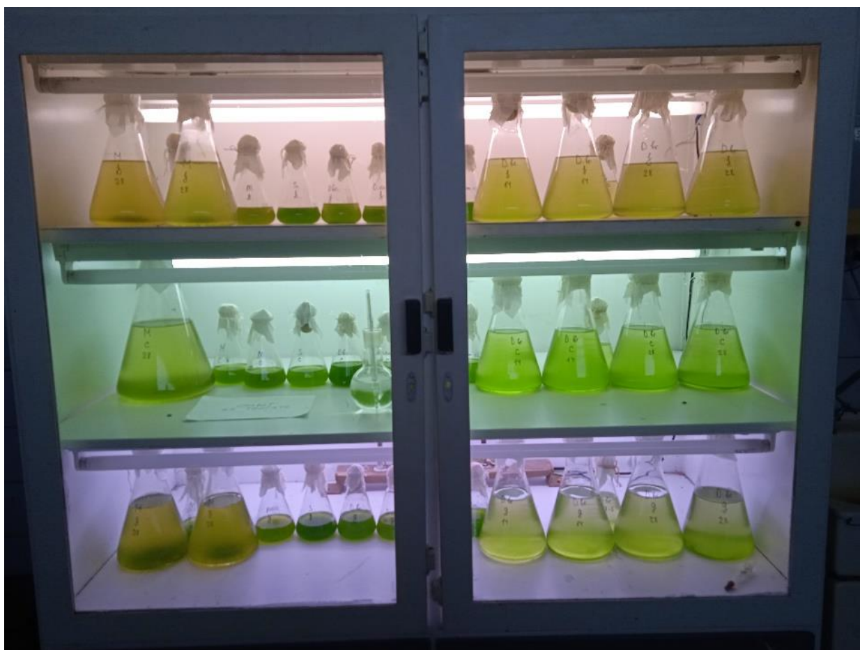
Рис. 2.3 Аквакамера для дослідження впливу PPFD та спектрів з різними довжинами хвиль на ріст зелених мікродоростей.
