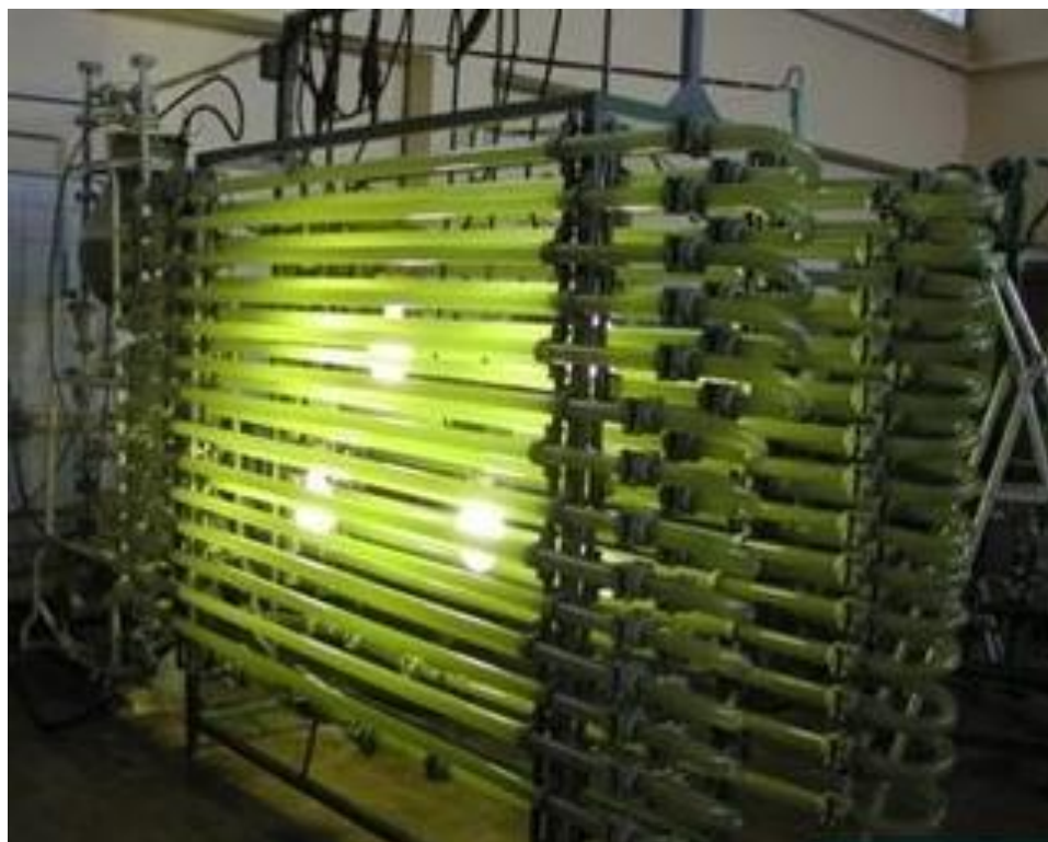
Рис. 6.4 Фітобіореактор закритого типу для культивування мікроводоростей (Інститут гідробіології НАН України).
