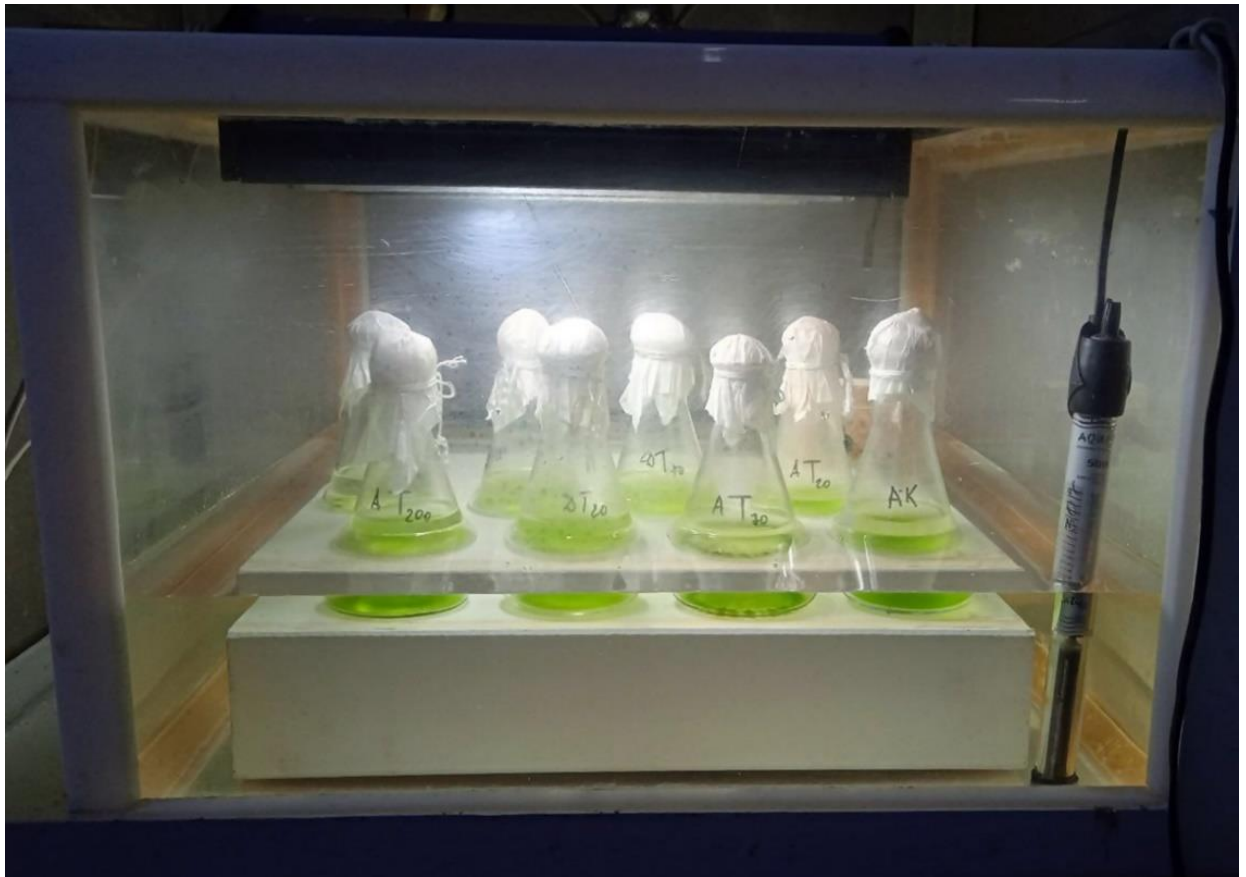
Рис. 2.1 Аквакамера для дослідження дії температури за константного та динамічного режимів на ріст та розмноження мікроводоростей при неперервному культивуванні.
